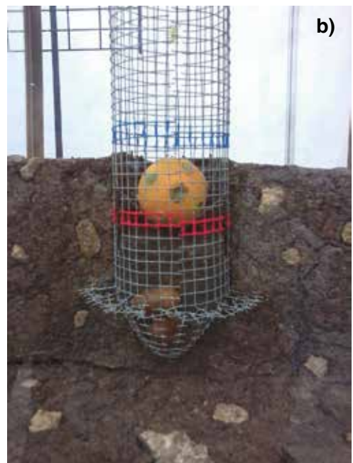
Figura 59. Esquema y aspecto del protector «Universidad de Valladolid».
